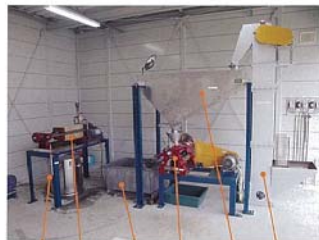
油 レシーバー 原油 レシーバー 原料 ホッパー 精油機 搾油機 バケット エレベーター
