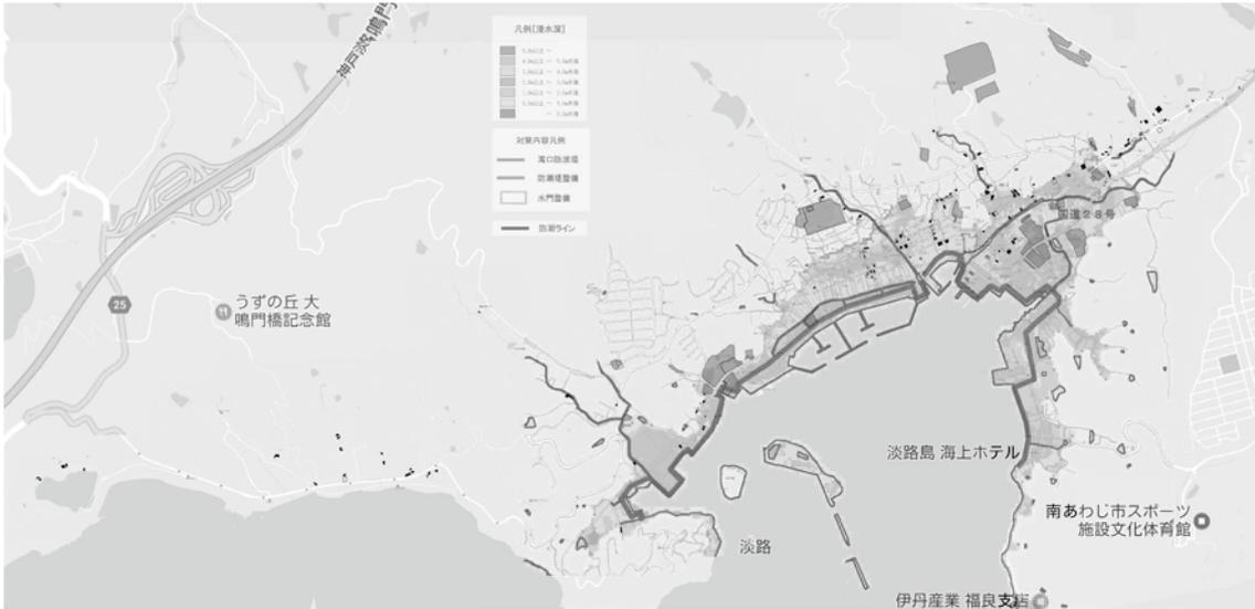
図5-10-10 地区詳細レベル地図+L1 津波・湾口防波堤等整備前浸水域
