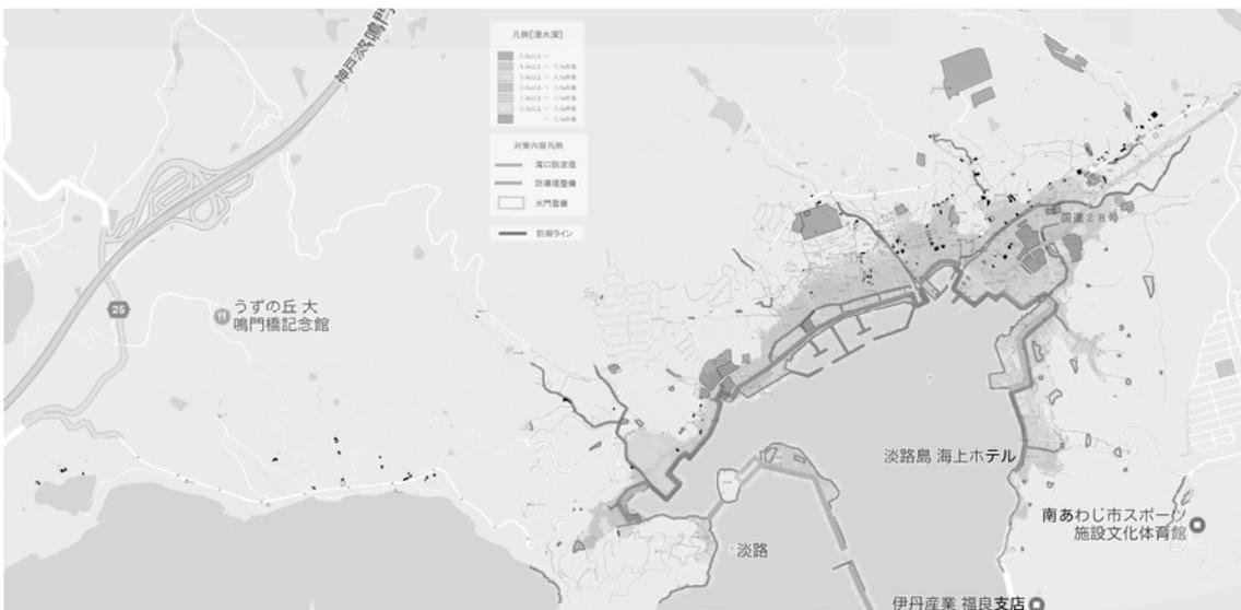
図 5-10-9 地区詳細レベル地図+L2 津波・湾口防波堤等整備後浸水域
