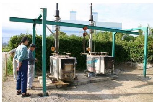
第 4-3-10 図 エコ炭銀行でご使用されている炭焼窯 19)
