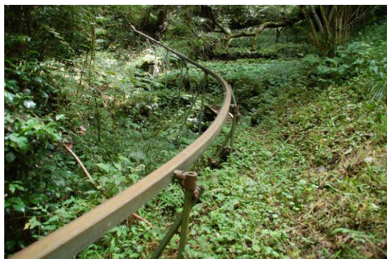
水わさびを収穫するためのトロッコのレール
