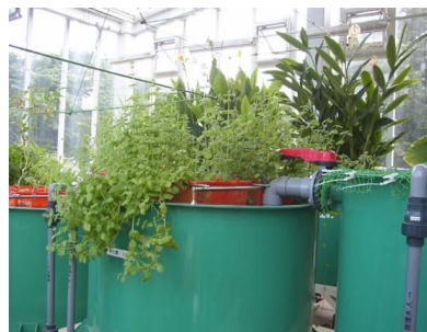
植物による污水浄化実験プラント 86)
