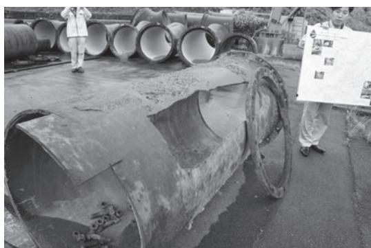
写真-2 大阪ガスのダクタイル鉄管の被害
