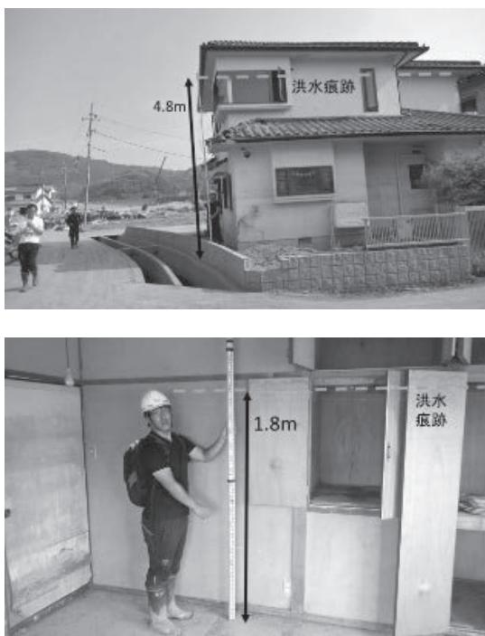
図 13 真備地区での浸水痕跡
